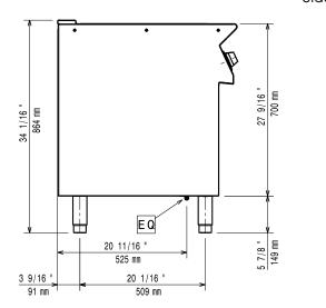
Electrical inlet (power) Equipotential screw
